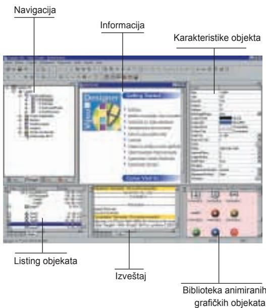
Vijeo Designer programski alat omogućuje izradu aplikacija za operatorske panele i računare kod sistema za automatsko upravljanje, i to za XBT GT, GK, GTW panele i Smart & Compact iPC. On takođe omogućuje upravljanje multimedijalnim funkcijama XBTGT-a i Smart & Compact iPC-a (video i audio) i nudi korišćenje Ethernet priključaka i iPC daljinskog pristupa preko Web strana (WEB Gate funkcije).
